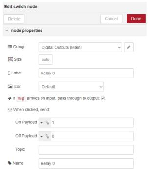
Wichtig ist dass der Datentyp von "On Payload" und "Off Payload" eine Zahl (number) ist und für "On" eine 1 und für "Off" eine 0 eingetragen wird.
