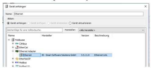
Im "Gerät anhängen" Fenster den Eintrag Feldbusse aufklappen und den Eintrag "Ethernet Adapter" finden und auch diesen aufklappen. Nach dem Anklicken des Eintrags "Ethernet", können wir jetzt einen "Ethernet Adapter" zu unserer Steuerung hinzufügen, dies geschieht mit einem Klick auf die Schaltfläche "Gerät anhängen" unten rechts im Fenster.
