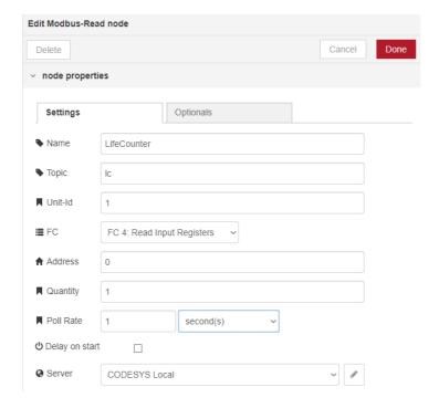
Damit sind die *Modbus read* Knoten konfiguriert und können verwendet werden. Im nächsten Schritt stellen wir noch die *Modbus write* Knoten ein, bevor wir alle Knoten verbinden und die Einstellungen für unsere Web-Visualisierungs Knoten vornehmen.
