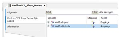
Über diese beiden Namen erhalten wir später im *CODESYS* Programm Zugriff auf die Daten die wir von *Node-RED* erhalten bzw. die wir *Node-RED* als Information zur Visualisierung zur Verfügung stellen.
