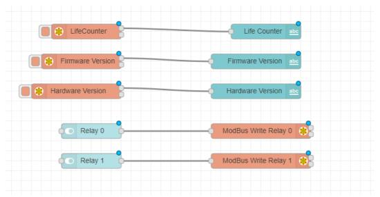
**9.** Sind alle Knoten verbunden, so ist der Flow für unsere Web-Visualisierung fertig und mit einem Klick auf "*Deploy*" wird alles an den *Node-RED* Server übertragen. Der Flow startet automatisch mit seiner Arbeit.
