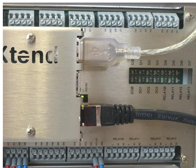
Abbildung 1: USB Ethernet Dongle anschließen
