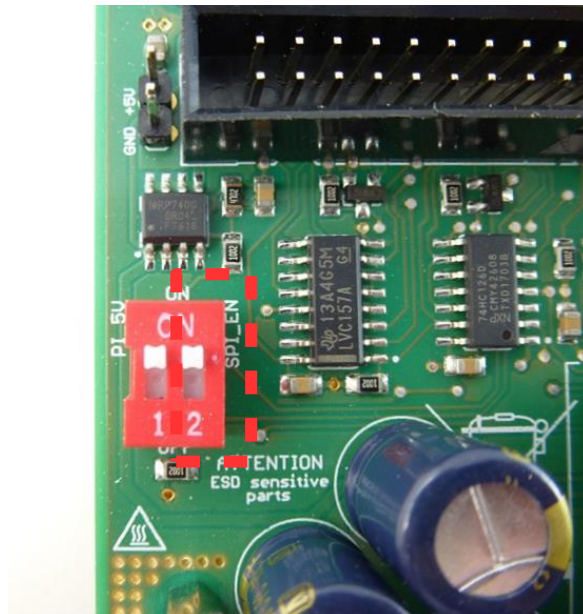
Abbildung 28: Schalter – „SPI_EN“
