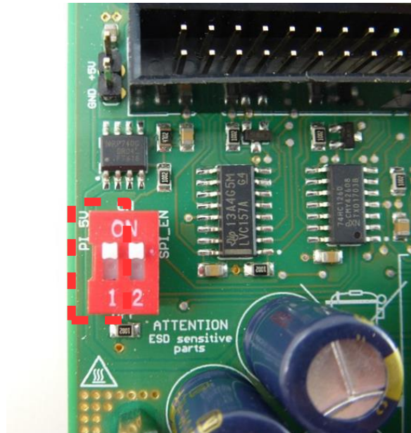
Abbildung 29: Schalter - „PI_5V“ in der Stellung „ON“
