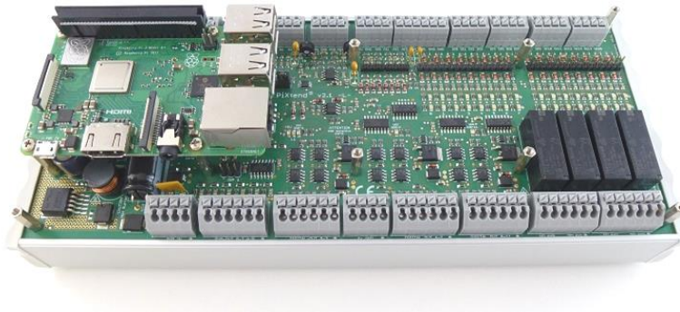
Abbildung 14: Hutschienegehäuse montiert
