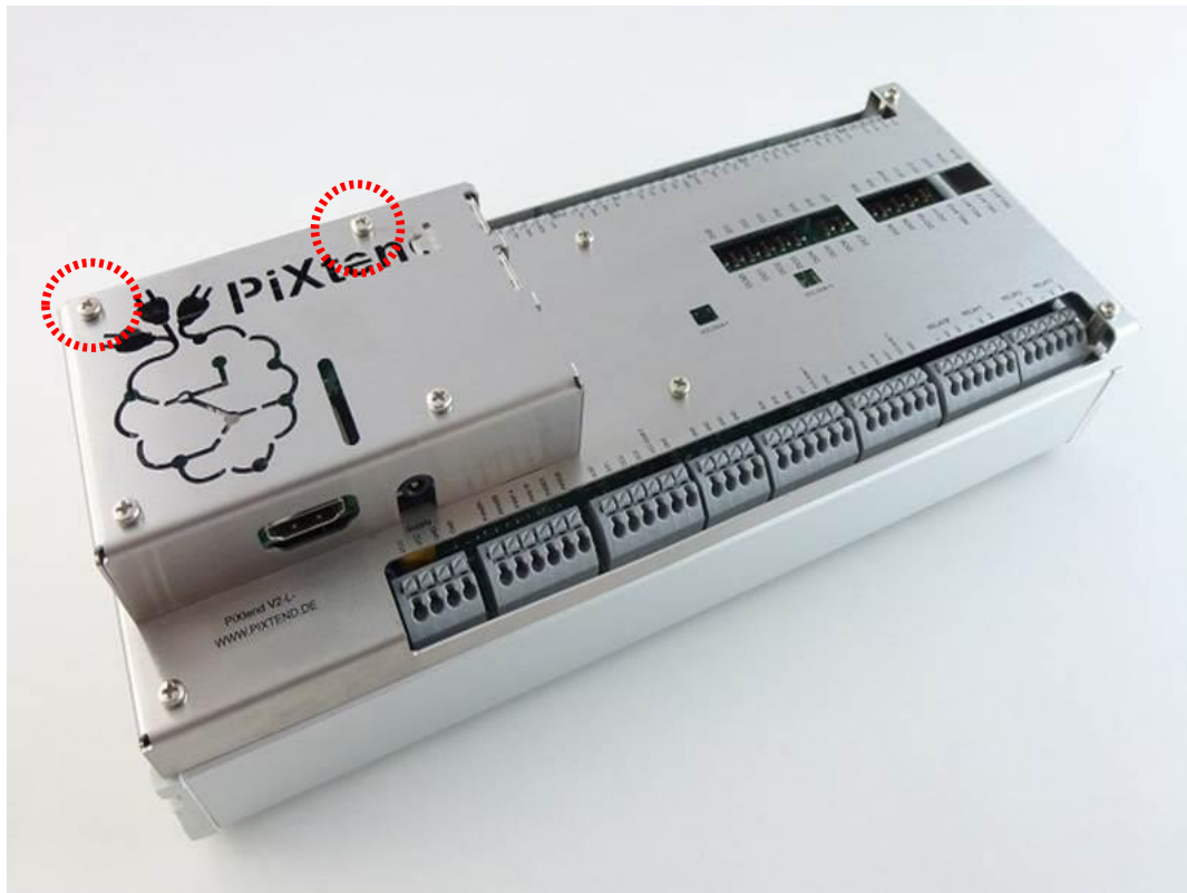
Abbildung 26: Edelstahlhaube fertig montiert
