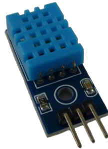
Abbildung 80: Temperatur- und Luftfeuchtesensor DHT11
