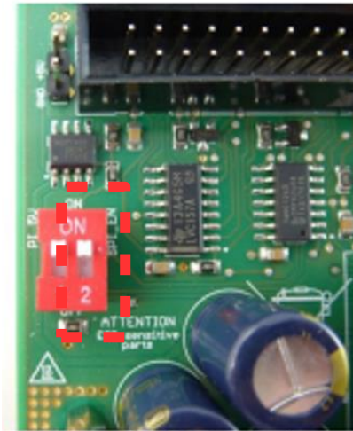
Abbildung 51: DIP-Schalter: SPI_EN
