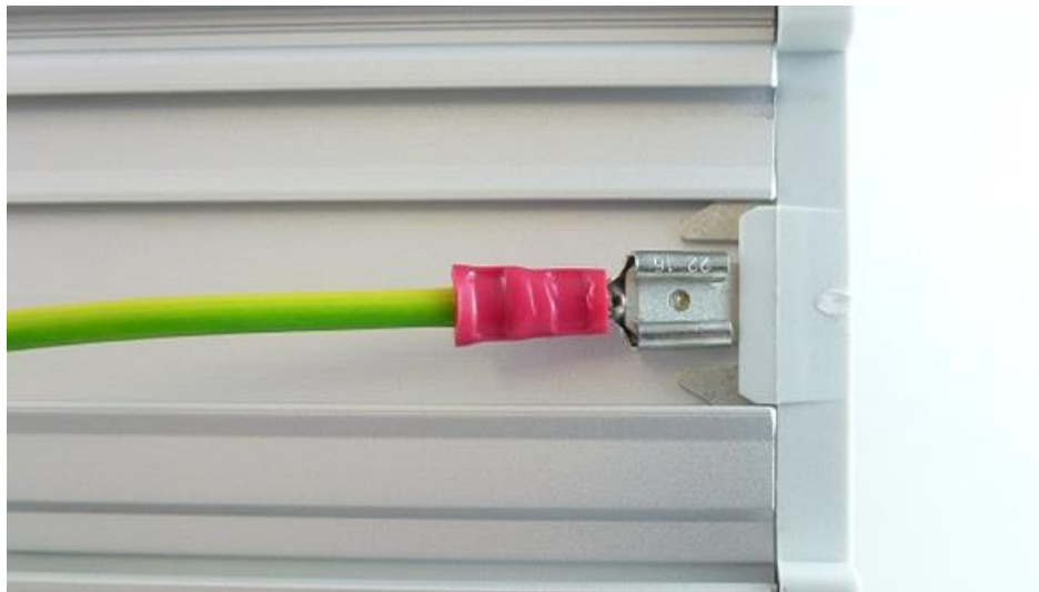
Abbildung 16: Hutschienengehäuse - Schutzleiter (PE) angeschlossen
