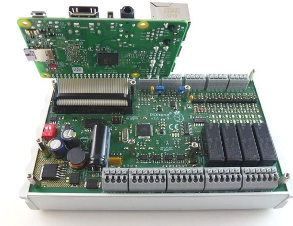
Abbildung 19: Raspberry Pi von PiXtend gelöst (Flachbandkabel bleibt verbunden)
