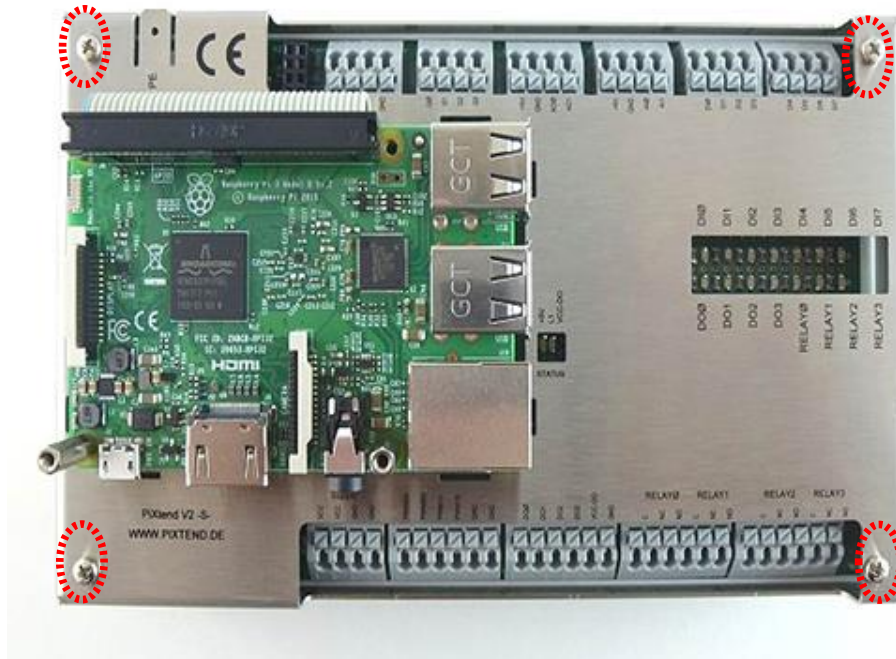
Abbildung 22: Unteren Haubenteil fixieren
