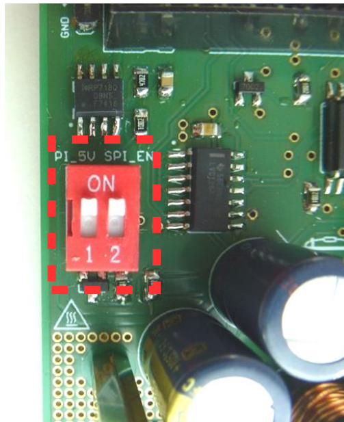
Abbildung 28: Schalter – „SPI_EN“
