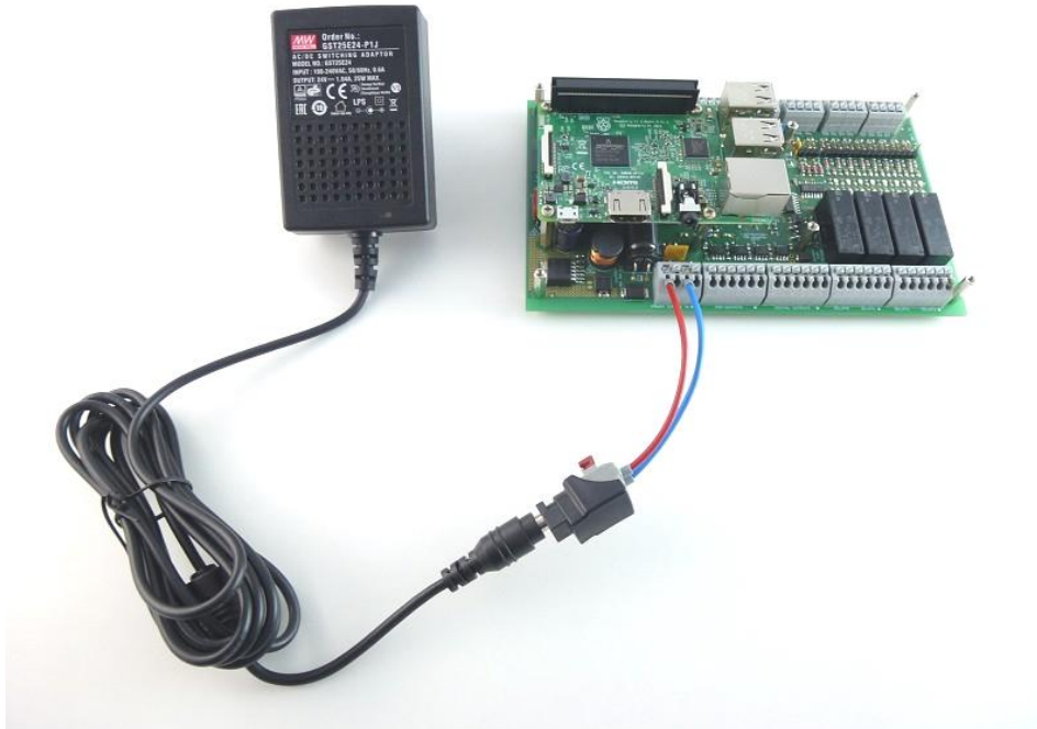
Abbildung 36: Anschluss des Netzteils an PiXtend V2 -S-
