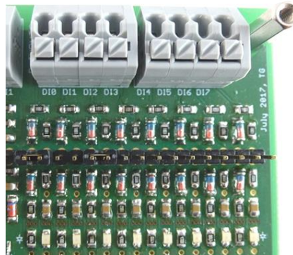
Abbildung 52: Anschlussleiste - digitale Eingänge
