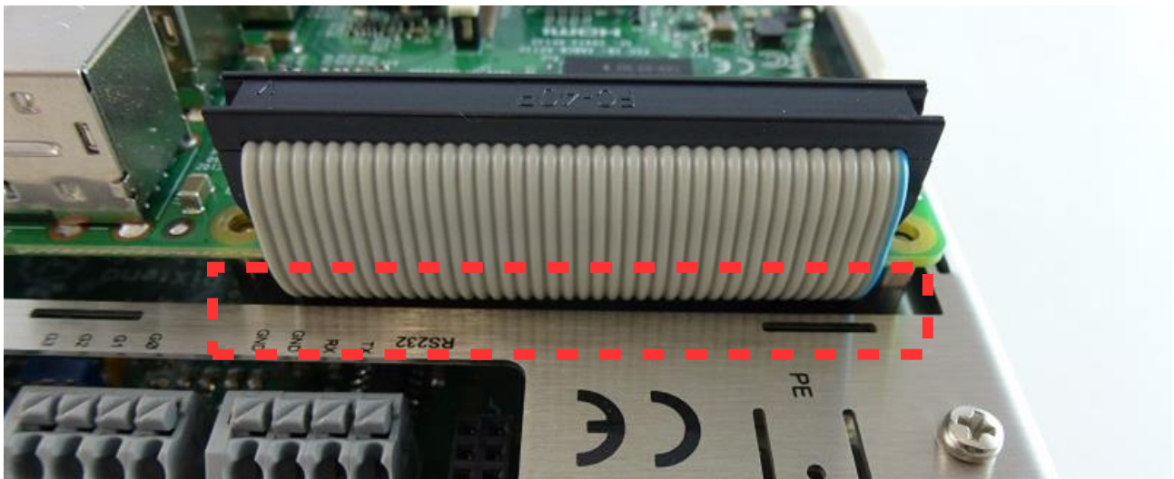
Abbildung 24: Sicherheitsabstand zwischen Flachbandkabel und Haube
