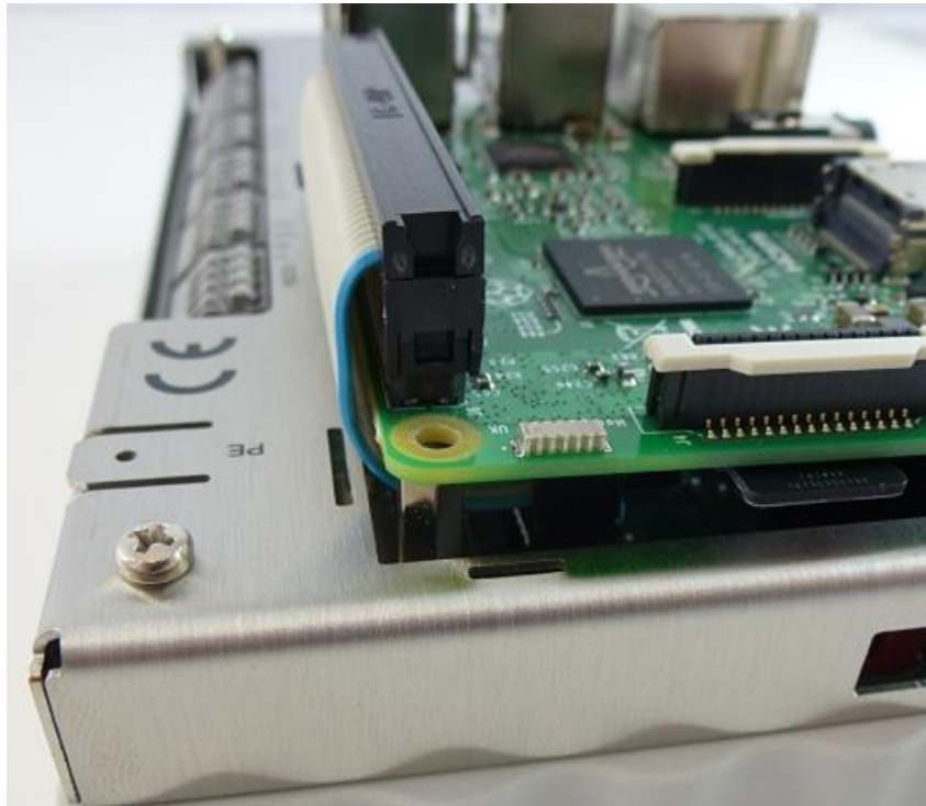
Abbildung 23: Optimaler Verlauf des Flachbandkabels
